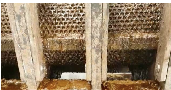
Imagen de la malla interna donde se ve la fracción líquida escurriendo (finos, grasa y agua) hacia la parte baja de la prensa
