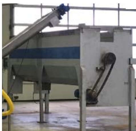
Entrada de harina mediante sinfín transportador desde prensa
