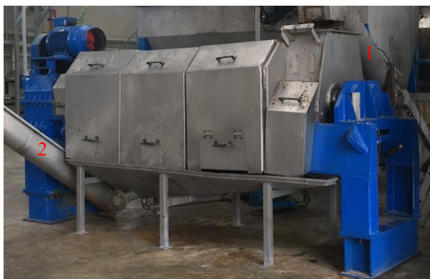
Prensa de doble usillo con sinfines para su alimentación desde la tolva intermedia (1) y para la salida hacia tolva final de la harina (2)
